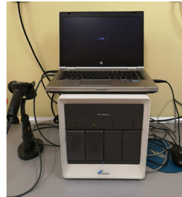
Aparat do oznaczania RNA wirusa SARS-CoV-2 (RT-PCR) w automatycznym systemie zamkniętym. Fot. nadesłana przez Autorkę
